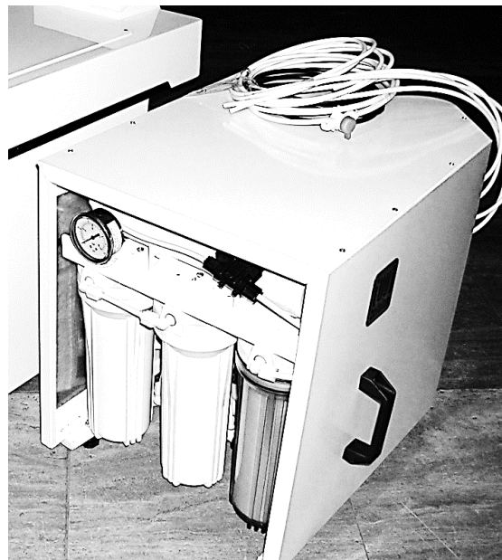
قسمت پایین دستگاه پیش فیلتر 2RO
